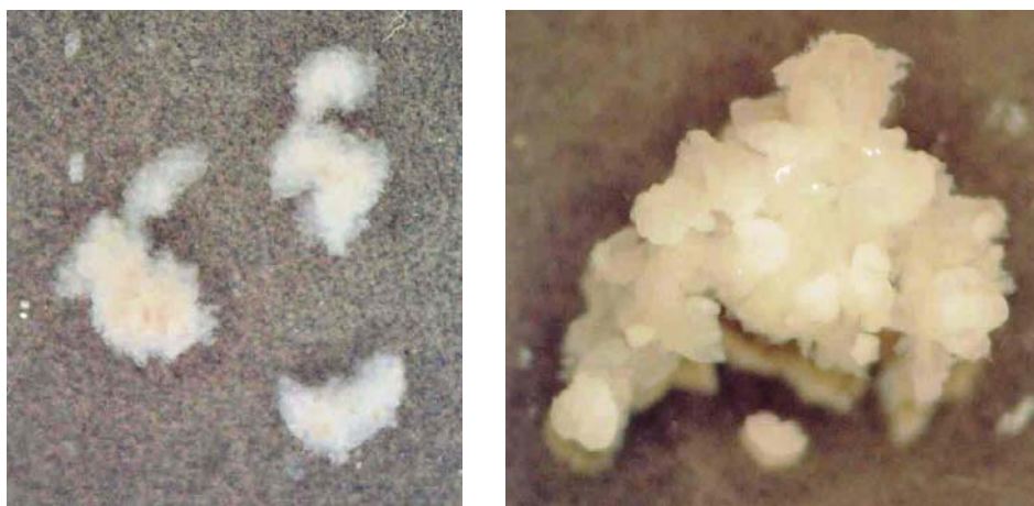
Figura 6.4. Izquierda: flóculo compacto de biomasa acidogénica, 10x. Derecha: Agregado de biomasa acidogénica adaptada a la degradación de almidón, 100x.
