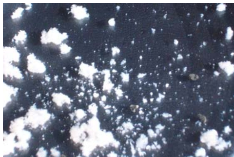
Figura 6.8. Biomasa acidogénica floculenta compacta de la etapa previa a la adición de calcio. Los gránulos negros corresponden a biomasa metanogénica.
