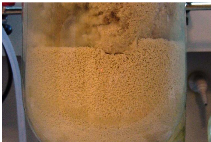
Figura 6.3. Biomasa desarrollada al cabo de 250 días de operación. TRH 3 horas.
