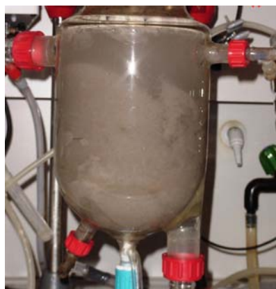
Figura 6.2. Lodo acidogénico de apariencia dispersa. Día de operación 125 con TRH de 6 h.
