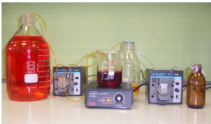
Figura 6.6. Equipo para la decoloración de Orange II en un reactor de tanque agitado con MnP inmovilizada
